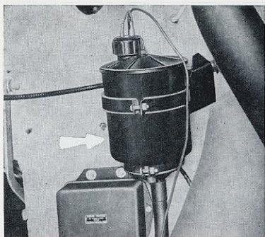
05-5 - Réservoir de liquide de servo-direction sur C.S.A.
