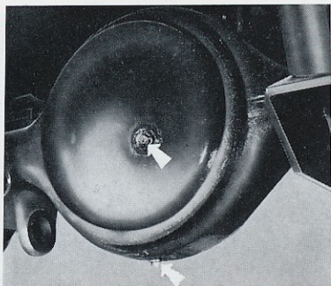
03-5 - Emplacement du bouchon de vidange et de niveau sur Pont AR n° 2 (chassis 6 x 4).
