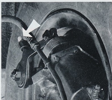
08-6 - Chapes sur levier de frein AV et réglage de frein (E 236 et E 252).
