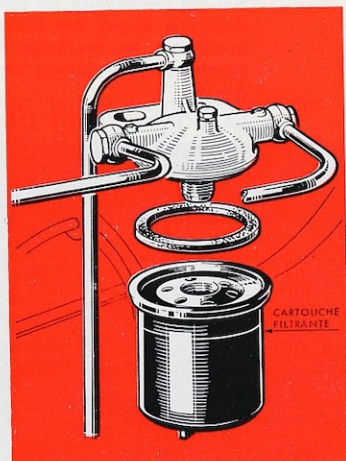
00-13 - Filtre à combustible.
