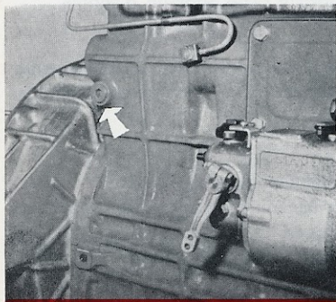
00-18 - Bouchon de vidange à l'arrière du bloc cylindres (6 cyl.)
